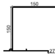
Bild 69: Querschnitt Rolladenkasten (SP-E 150)
