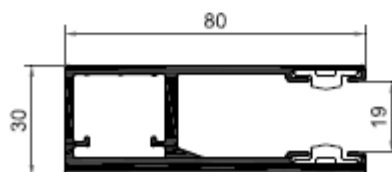
Bild 34: Querschnitt seitliche Führungsschiene (PPW80) mit Keder
